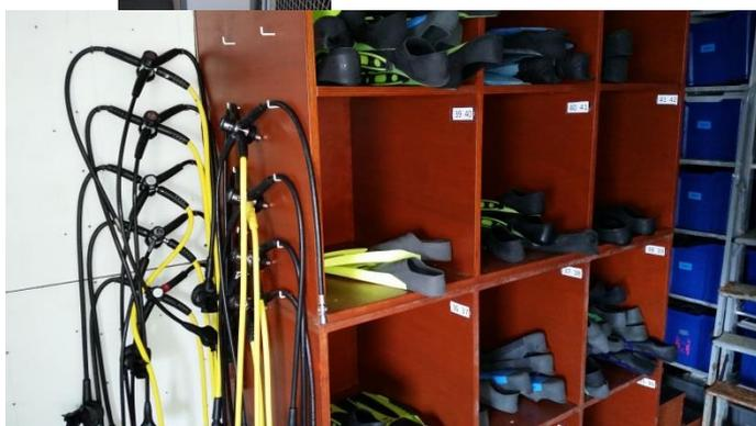
Les détendeurs accrochés au mur doivent être avec le DIN vers le bas pour favoriser l'égouttage, et le deuxième étage doit tremper 15 min dans le désinfectant avant le rangement.
