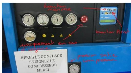
Les boîtiers d'arrêt d'urgence ne doivent pas être utilisés comme interrupteur. La coupure brutale peut endommager la carte électronique.
