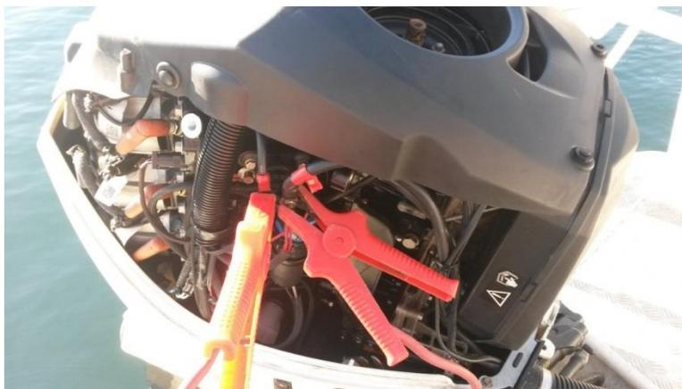
A l'aide du câble pince crocodile que vous trouverez dans une boîte à masque installé dans la boîte à outils dans le coffre, reliez les 2 bornes **1** et **2** ce qui lancera le démarreur, retirez le câble une fois le moteur
