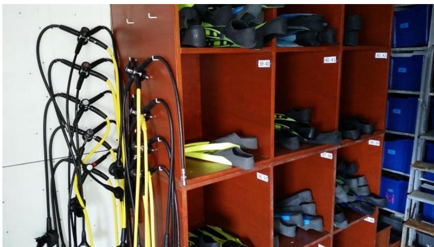
Les détendeurs accrochés au mur doivent être avec le DIN vers le bas pour favoriser le séchage
