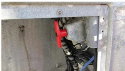
Enclenchez le coupe circuit dans le coffre sous la console de pilotage
