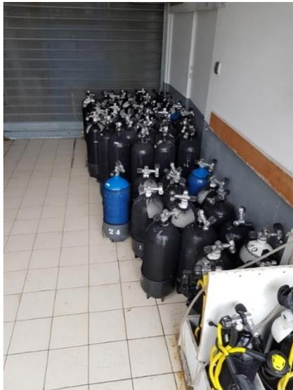
Les bouteilles sont rangées par volume en commençant par les bouteilles de sécurité pour armer les bateaux, leurs pressions et bons fonctionnements doivent être vérifiés avant.
